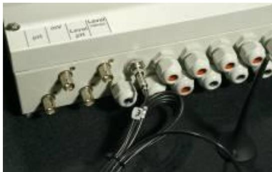
Die Abbildung zeigt den Antennen-Anschluß. Der FME-Stecker der Antenne wird in den entsprechenden Stecker am Geräte-Gehäuse eingeschraubt.
