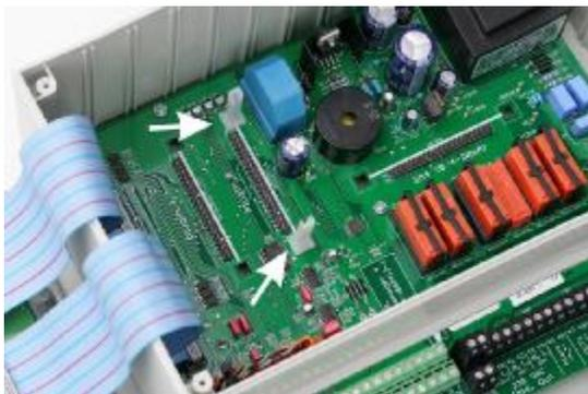
Im geöffneten Gerät werden zunächst die beiden Leiterplatten-Führungen in die dafür vorgesehenen Ausfräsungen am Steckplatz „Plugin 2“ gedrückt. Dabei ist darauf zu achten, dass die Führungsnuten jeweils nach innen zeigen.
