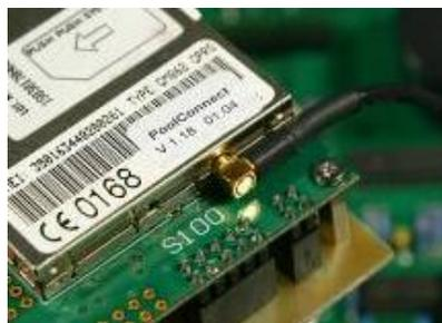
Am anderen Ende des Antennen-Adapter-Kabels befindet sich ein kleiner MMCX-Stecker. Dieser wird mit dem PoolConnect Modul verbunden, wie auf der Abbildung links zu sehen.
