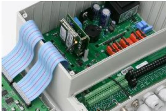
Die beiden Abbildungen oben zeigen, wie das PoolConnect Modul in den Steckplatz gesteckt wird.
